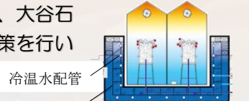
冷温水配管 輻射熱・気化熱発生装置 (大谷石)
